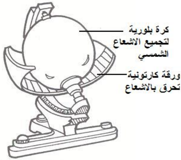
الشكل ٢-٣: كرة كامبل لقياس فترة الإضاءة.
