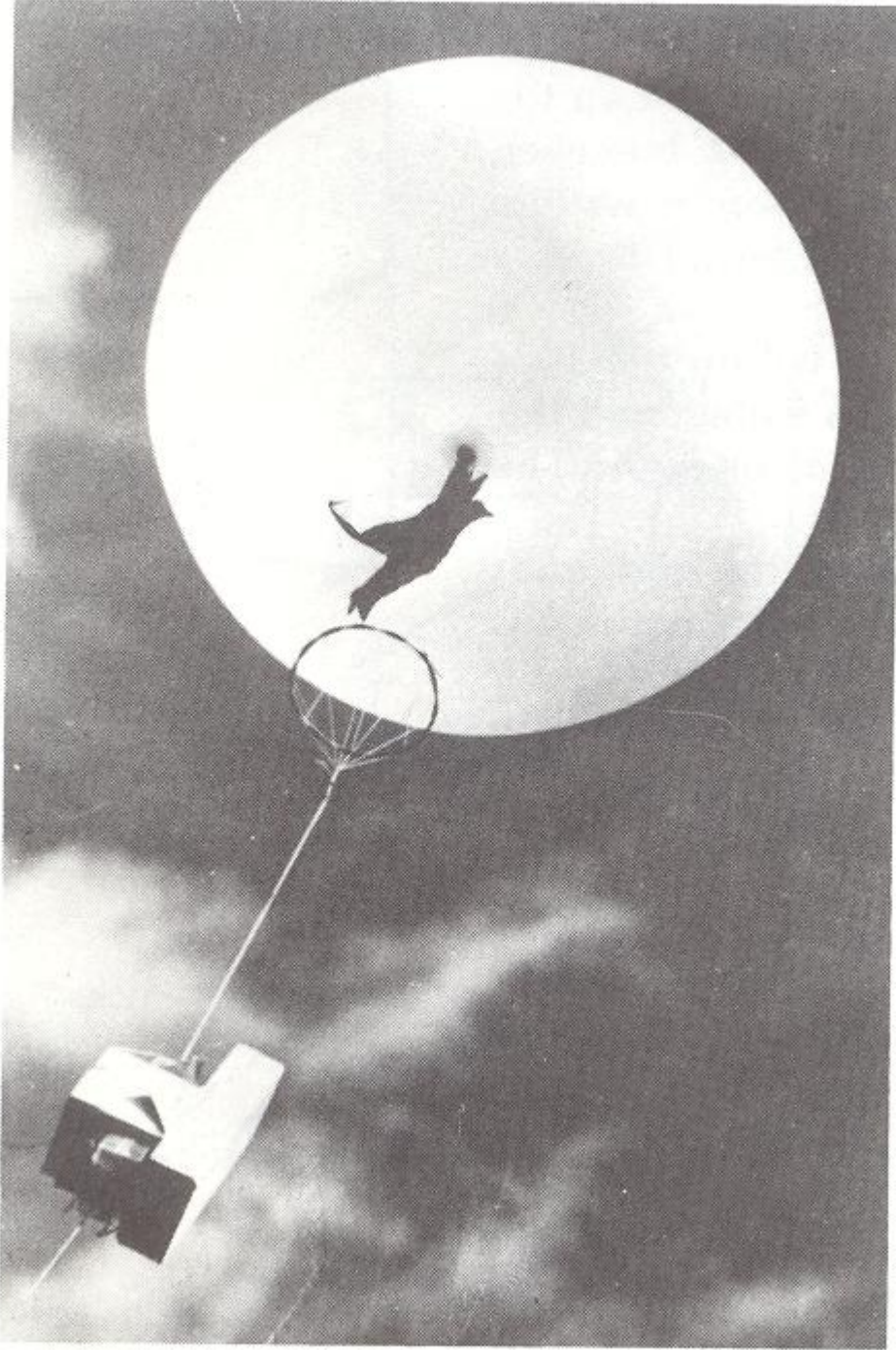
الشكل ١٠-١: جهاز الراديو سوند مربوط إلى بالون مطاخي فيه هيدروجين لإرساله إلى طبقات الجو العليا لقياس عناصر الطقس.
